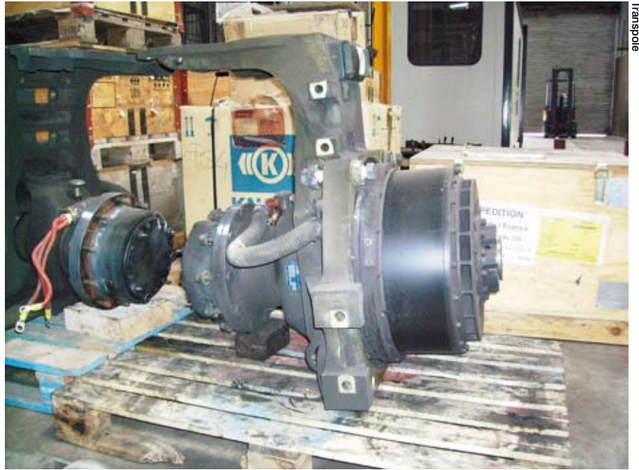
Ensemble déposé d'un moteur-roue fixé sur sa jambe de suspension
