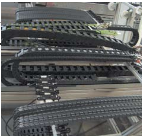
Test d'endurance d'une fibre optique réalisé dans le laboratoire igus : 60.000 km parcourus sans perturbation dans une chaîne porte-câbles
