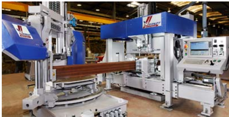
La solution Beckhoff représente un schéma idéal pour la commande des machines Vernet Behringer destinées au secteur de la charpente métallique
