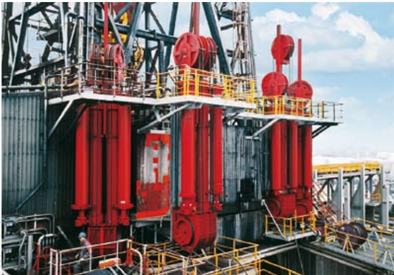
Système de compensation de la houle
