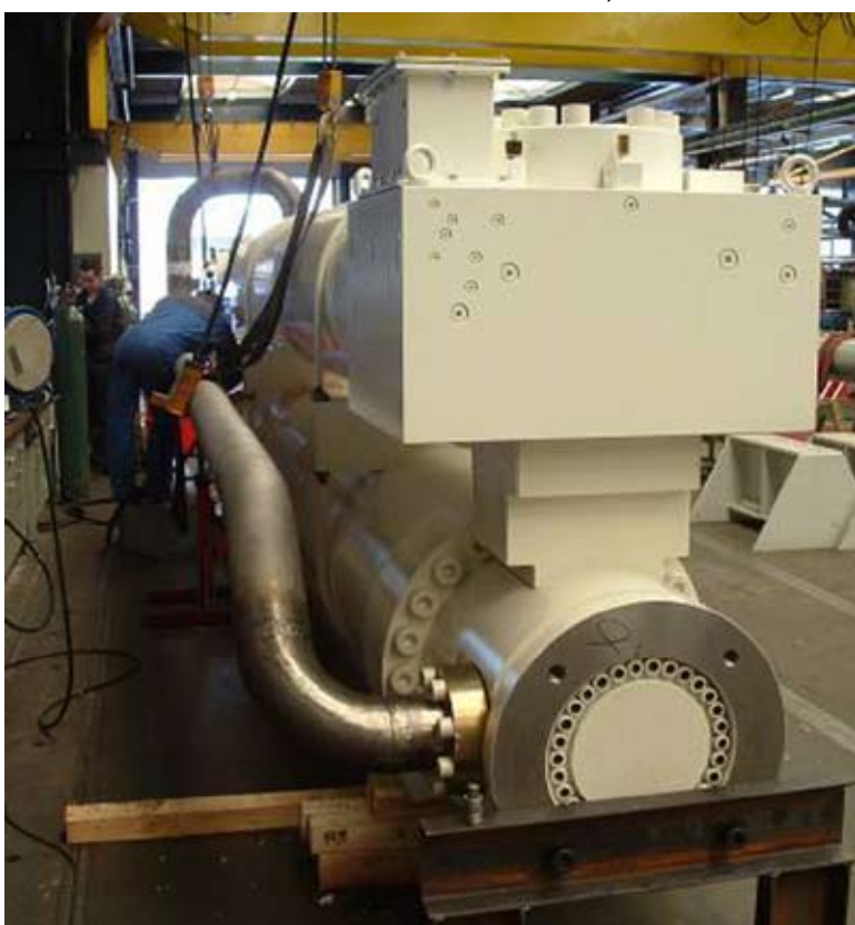
Système de compensation de la houle
