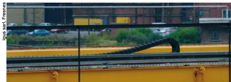
igus a remplacé les chariots à câbles de 17 grues à portique extérieures par des systèmes de chaînes porte-câbles « ReadyChain » entièrement confectionnés et prêts à être montés.
