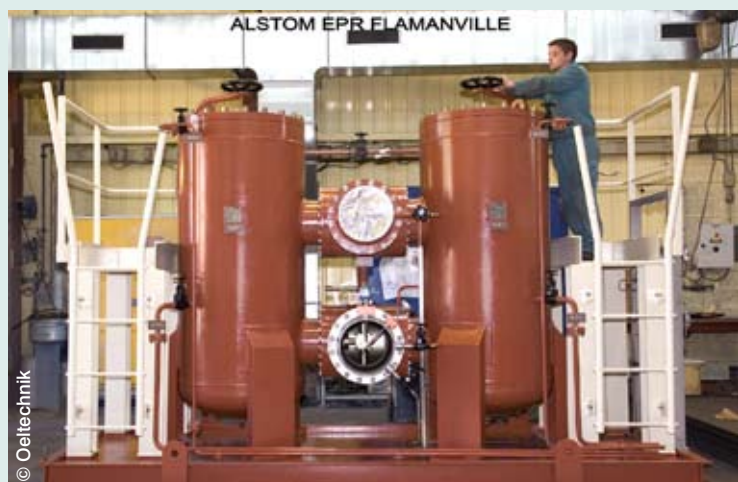
Groupe de filtration Oeltechnik constituant l'un des modules de la centrale de lubrification de la turbine vapeur pour l'EPR de Flamanville. Débit 14280 l/min.
