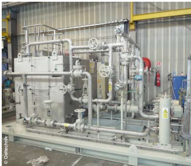
Centrale de lubrification Oeltechnik API 614. Débit 300 l/min
