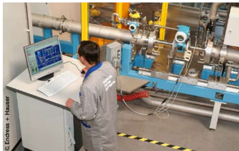
Le banc d'étalonnage de débitmètres d'Endress + Hauser à Huningue permet de réaliser des prestations d'étalonnage pour des appareils de diamètres compris entre DN8 et DN100. Il permet de traiter les débitmètres à principe électromagnétique, Coriolis et vortex, de la majorité des constructeurs.
