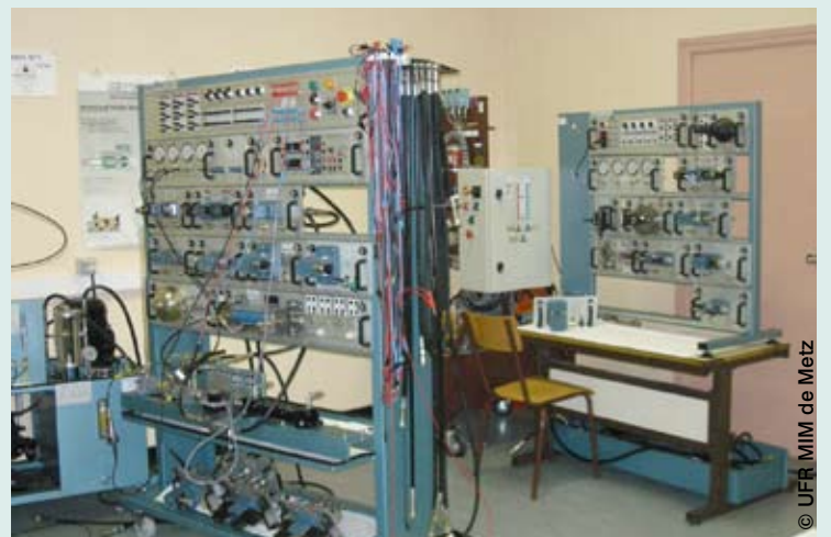
Les élèves de la licence "Hydraulique Industrielle et commandes associées" disposent de 5 bancs d'essais avec systèmes d'acquisition.
