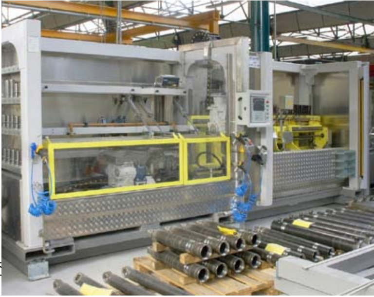
Banc d'assemblage et de contrôle de vérins (en pression, étanchéité interne et externe)
