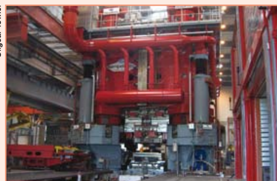
La presse à matricer de 40 000 tonnes de la société de fabrication de pièces pour l'aéronautique Airforge.
