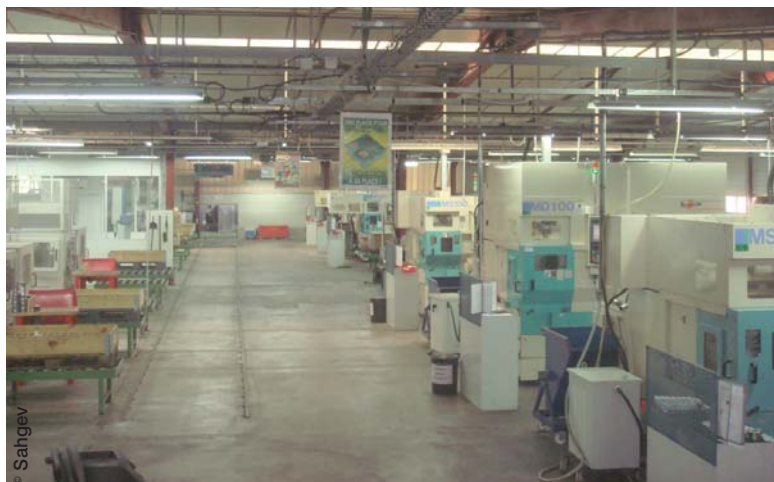
Une quinzaine de tours bi-broches et bi-tourelles robotisés équipent les ateliers de Sograydis qui, pour répondre aux exigences des nouveaux marchés en termes de qualité, s'est récemment dotée d'une machine de contrôle tridimensionnel.
